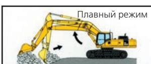
Стрела плавно поднимается, практически не отрывая переднюю часть машины от грунта. Это упрощает набор ковшом породы после взрыва и планировку грунта.
