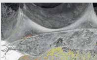
Зубья звездочки. Полный износ
