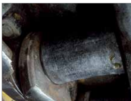
Износ втулки составляет 30%
